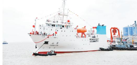
3月24日，“张寒”号科考母船停泊在码头。当日，我国万米级载人深潜器的科考母船“张寒”号成功建造，在浙江温岭举行下水仪式。由泰和海洋科技集团与上海彩虹鱼海洋科技股份有限公司共同投资建造的“张寒”号，船长97米，船宽17.8米，设计排水量4800吨，设计吃水5.65米，巡航速度12节，续航力15000海里，载员60人。新华社记者 张建松 摄
