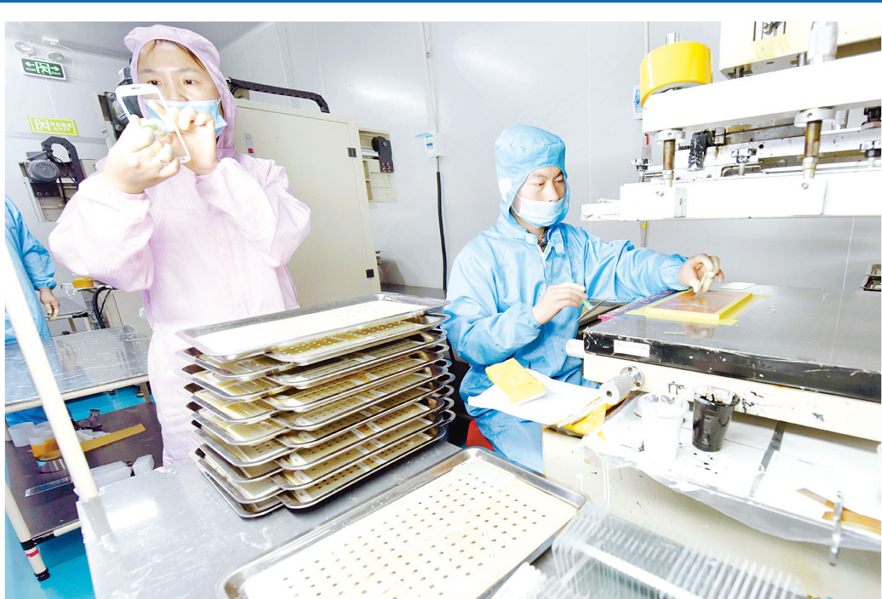
6月2日,位于东城产业集聚区的众弘光电科技有限公司员工正在生产触摸屏。该企业是一家专注于触摸屏研发、生产、销售的民营高新技术企业。项目一期投资6000万元,年产TFT-LCD电容式触摸屏300万片,年产值6000万元。
