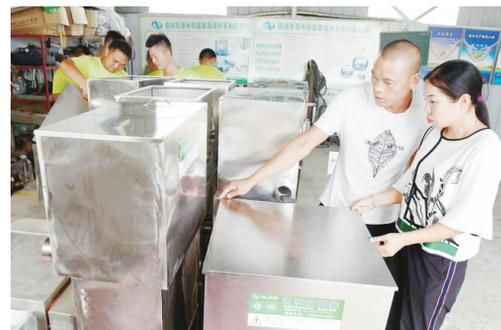
7月11日,位于临颍县台陈镇的漯河金顶环保能源公司的员工正在检查新制作的油水分离器,然后装车发送给客户。据悉,该企业利用这种设备可将污水中的油分离出来进行再加工,制成生物柴油等产品,实现循环利用。
