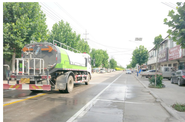
洒水车循环作业,有效减少路面扬尘
