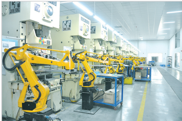
电子信息产业集聚发展,异军突起。图为源德福科技机械臂五金冲压生产线。
