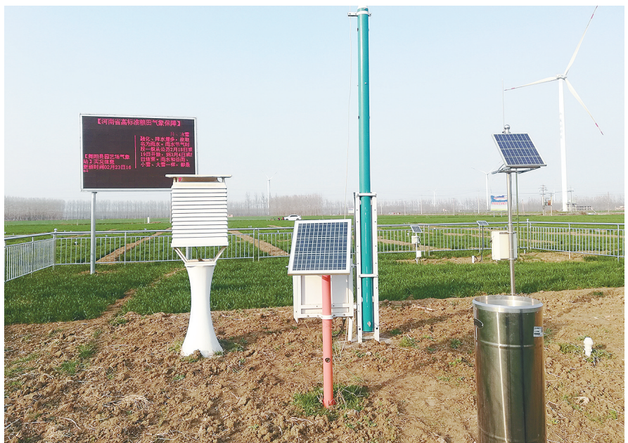
示范方里的气象自动监测点，能显示土壤水分、空气湿度等数据。
