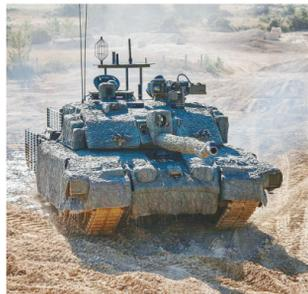
改装，改装内容包括简易爆炸装置监测装备和ECM电子对抗天线组件，炮塔上则加装了“强制者”遥控武器站。
