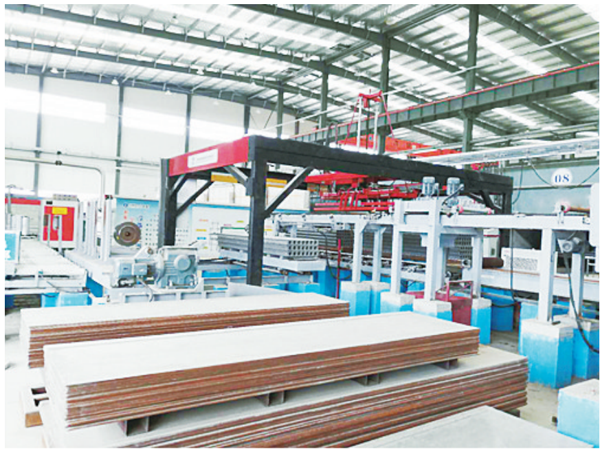
装配式建筑自动化墙板生产线。
