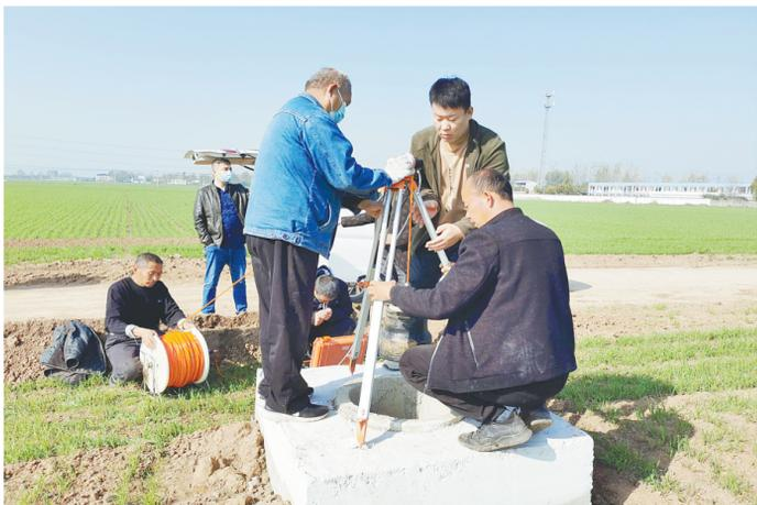
高标准农田建设工作人员在检测刚打好的灌溉机井深度。
