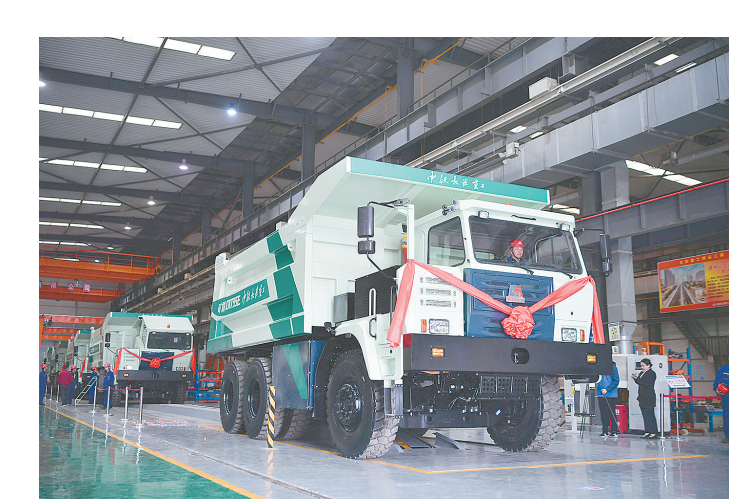
3月22日，中铁长安重工有限公司的工人在生产线上试乘即将下线的95吨纯电动矿用自卸车。 当日，由中铁长安重工有限公司自主研制的95吨纯电动矿用自卸车在西安市阎良区批量下线。近年来，该公司研制的大吨位电机车组、纯电动装载机、纯电动出渣装备等新能源工程设备产销两旺，助力绿色生产。
