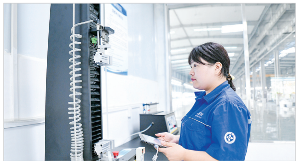
工作人员正在对样品进行拉力检测。
