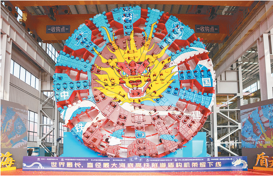
这是1月10号在铁建重工长沙第一产业园拍摄的“定海号” 超大直径盾构机。当日，由中铁十一局和铁建重工联合打造的超大直径盾构机“定海号”在长沙顺利下线，其最大开挖直径14.57米，总重量达4350吨，将投用于世界最长的海底高铁隧道——甬舟铁路金塘海底隧道建设。
