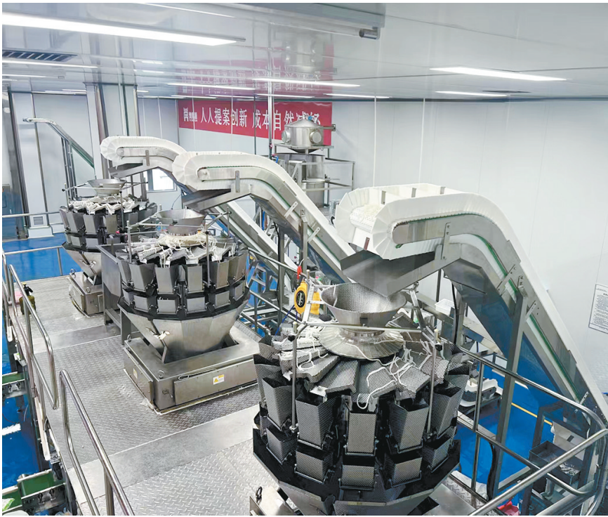
豫鼎源公司自主研发的国内第一条湿粉条自动化包装生产线。
