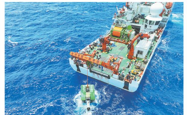
日前，我国深海矿产资源开发关键技术与装备研制取得重大突破，由上海交通大学自主研制的深海重载作业采矿工程样机“开拓二号”成功完成海试。“开拓二号”连续完成5次着底采矿，取回深海多金属结核与结核，实现深海重载作业采矿水试水深首次突破4000米，最深达4102.8米，在国内首创深海复杂海底地形高机动行进、深海多矿类复合钻采等深海采矿领域多项技术。图为上海交通大学自主研制的深海重载作业采矿工程样机“开拓二号”海试现场（无人机照片，6月22日摄）。新华社发
