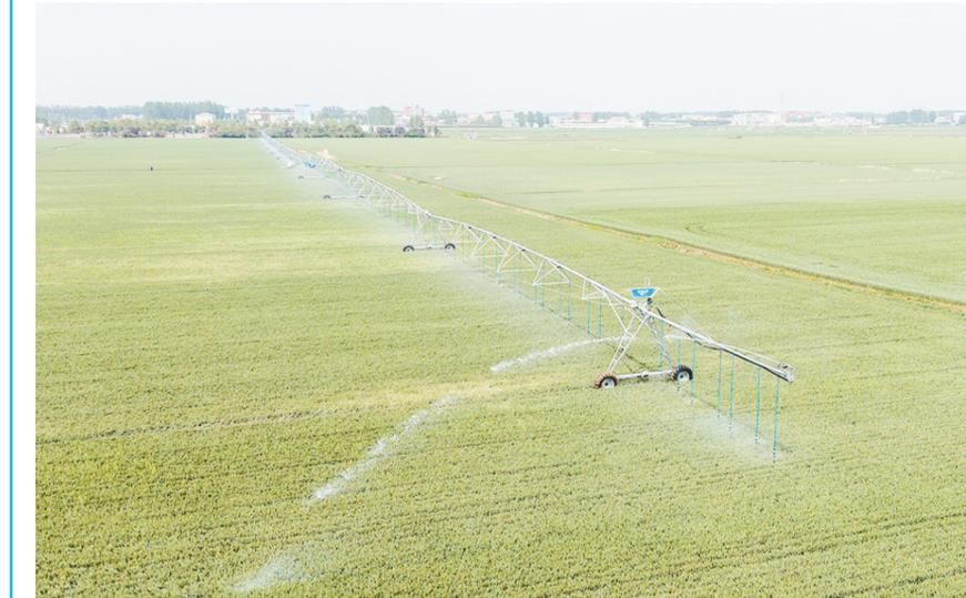
4月18日,在舞阳县北舞渡镇,自走式平移喷灌机正在为麦田浇水。据了解,该设备能在两天内把1000亩地浇灌一遍,有效缓解旱情。本报记者 杨光摄
