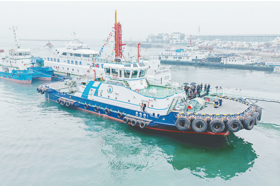
6月26日,国内首艘氢电拖轮——“氢电拖1”轮在山东港口青岛港入列。该拖轮搭载“氢燃料电池+液冷锂电池”混动系统,可实现零碳排放。该轮投产后,预计每年可减少二氧化碳排放1500余吨。
