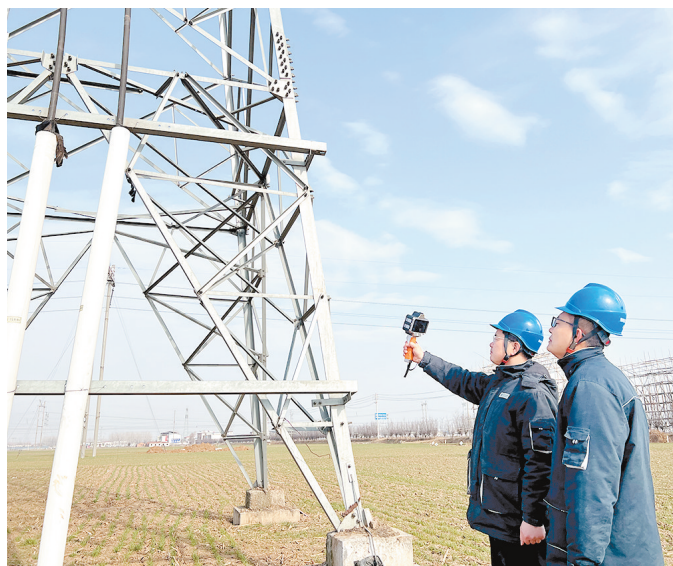
工作人员手持红外测温仪对设备进行测温。 本报记者 张玲玲 摄
