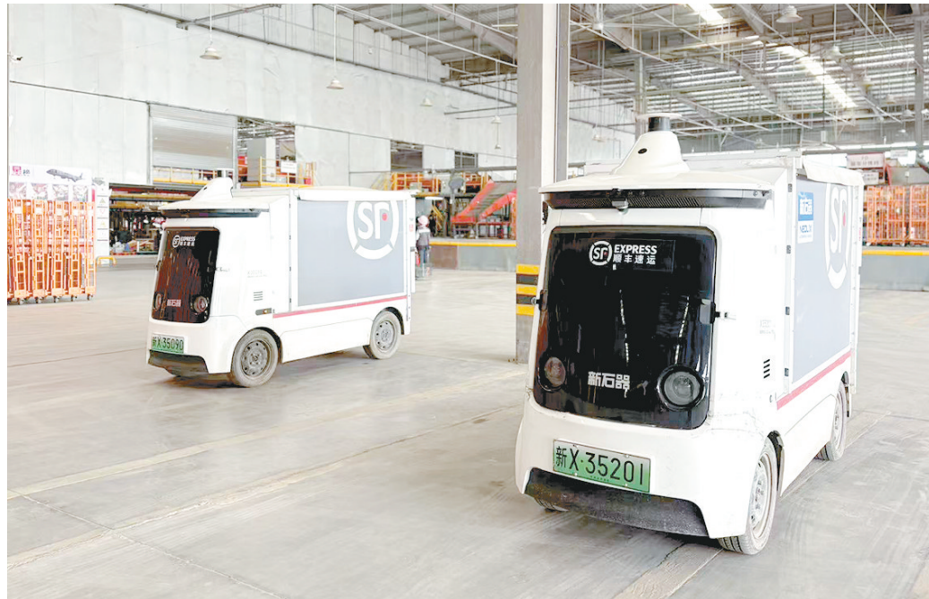
在AOI区域，包裹经自动化分拣后装入专用转运笼具，再由无人配送车转运至各末端网点。
