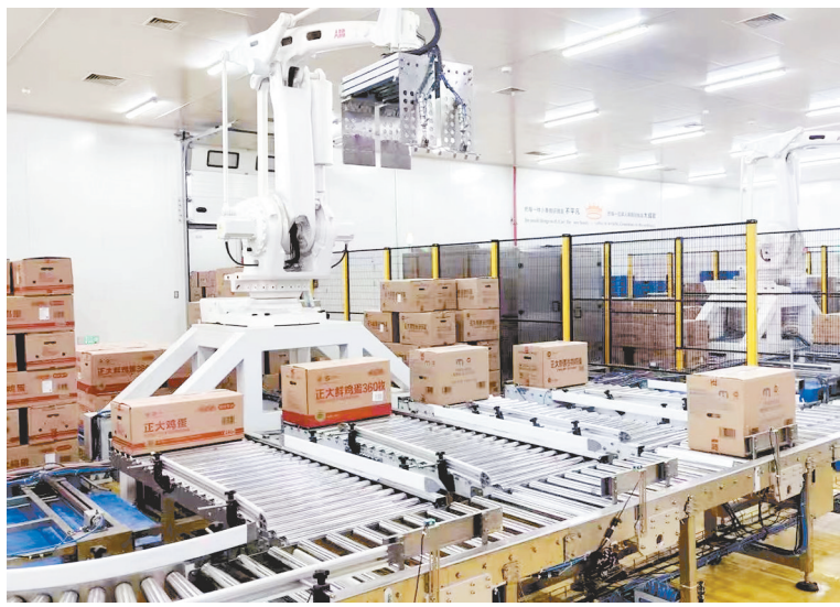
在蛋品分级包装车间,自动码垛机正在工作。图片由受访企业提供
