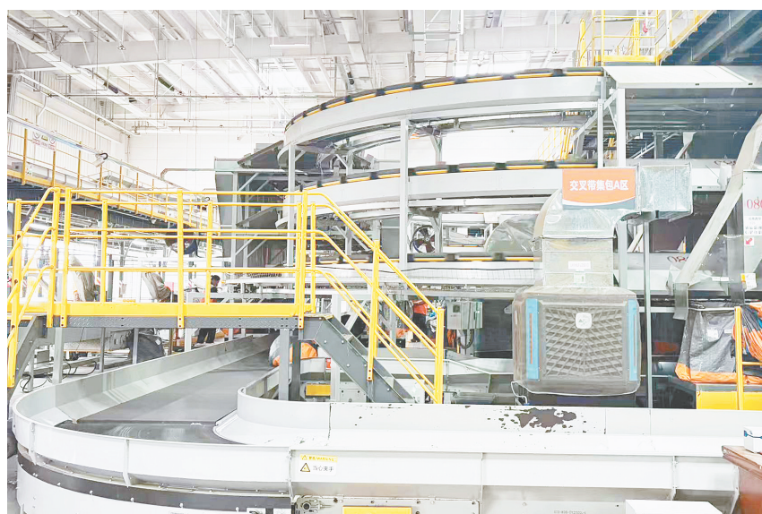
漯河申通的三层高速交叉带分拣设备正在对快递包裹进行智能识别。
