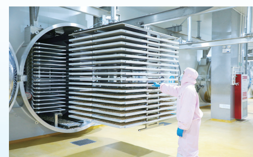
中誉宠物食品二期冻干车间内，工作人员正在生产线上作业。
