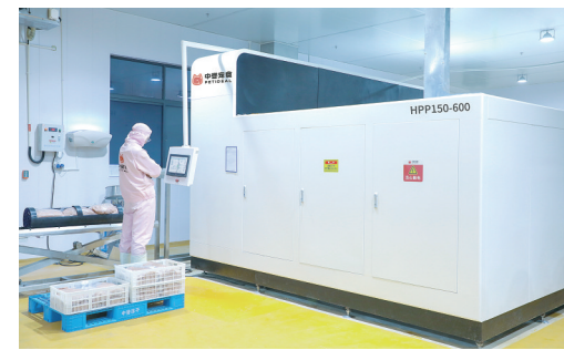
工作人员正在操作超高压灭菌设备。
