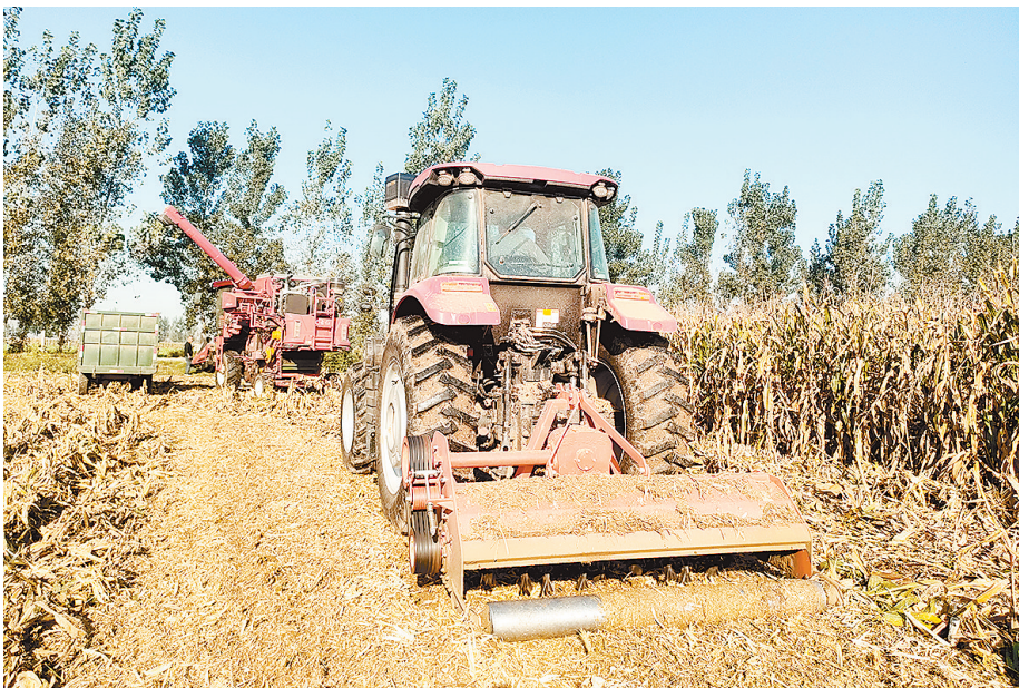
收割机将玉米收割、脱粒后，秸秆粉碎还田机紧随其后，将秸秆粉碎还田。
